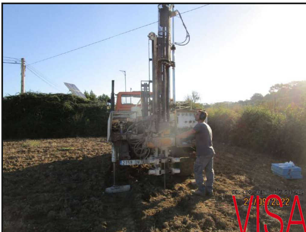
Foto 3: Detalle de la realización del ensayo penetrométrico
