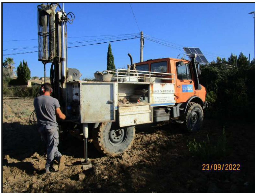
Foto 4: Detalle de la realización del ensayo penetrométrico P-2.
