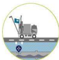
Detección de helio en los puntos de fuga.
